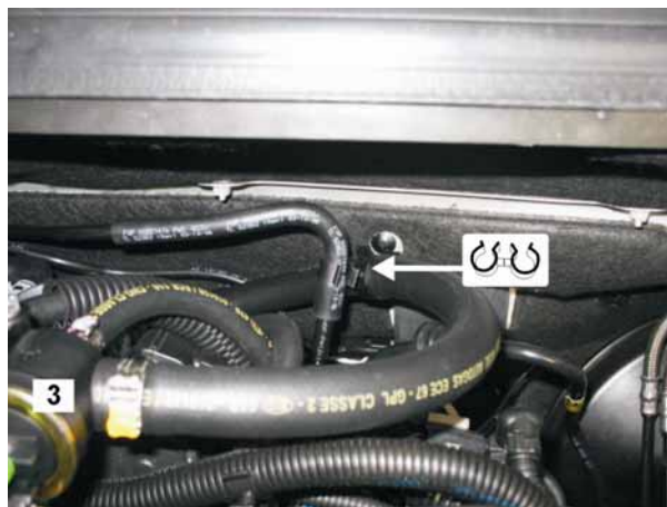
Fig.28 - tubo gas / tubo benzina sulla paratia abitacolo
