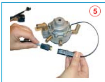
Figura 5: Installazione del sensore di temperatura. (GPL/ METANO)
