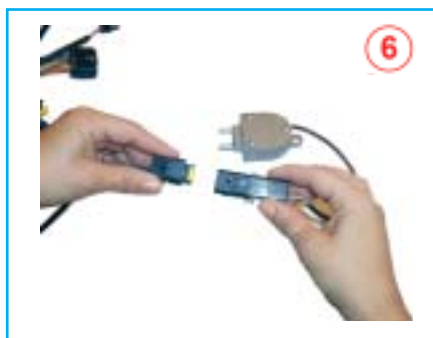
Figura 6: Sensore di Pressione ( GPL / METANO )
