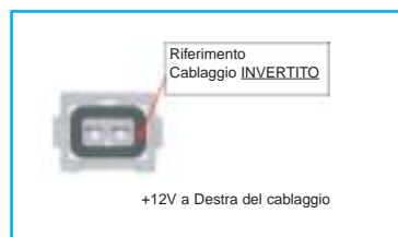
Figura 10: Cablaggio invertito
