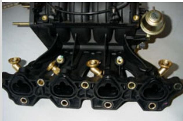
6. GSI-injectors / GSI-injectoren / Injecteurs GSI /
