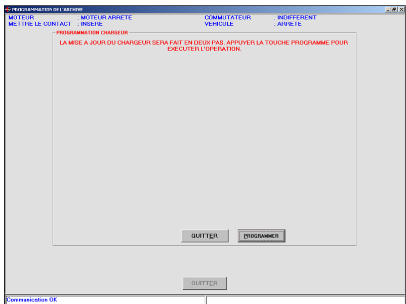
Fig. 4.40a - Mise à jour du chargeur si sur la centrale sa version est inférieure à 106
