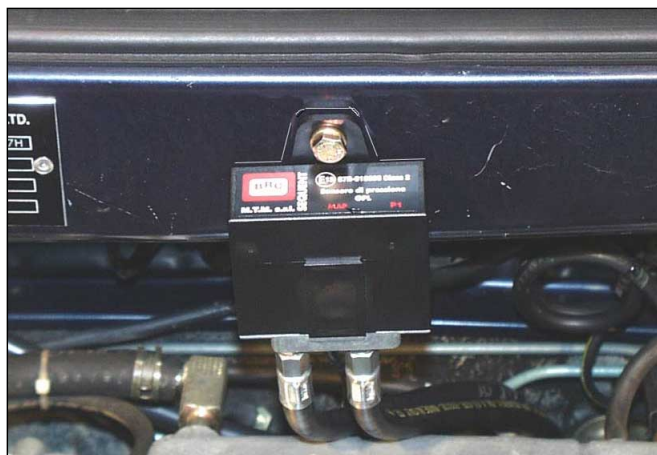
Fig. 32 Exemple d'installation Capteur de pression P1-MAP
