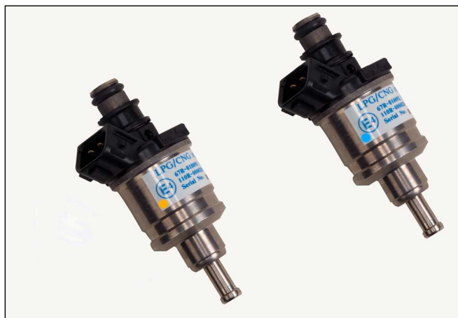
Fig. 14 Injecteurs Keihin type "Normal" et type "Max"
