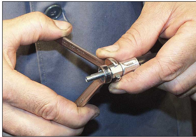
Fig. 39 Serrage buse sur raccord du tuyau
