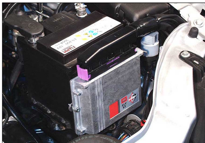
Fig. 43 Montage centrale dans le compartiment moteur
