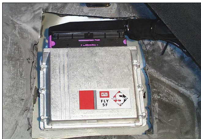
Fig. 42 Montage de la centrale dans l'habitacle
