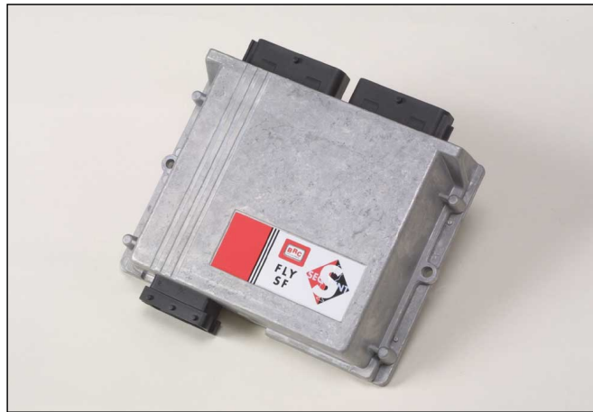
Fig. 21 Centrale FLY SF: version à deux connecteurs
