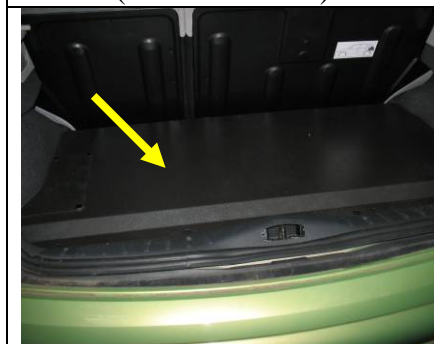
Carter de protection réservoir (sous coffre AR)
