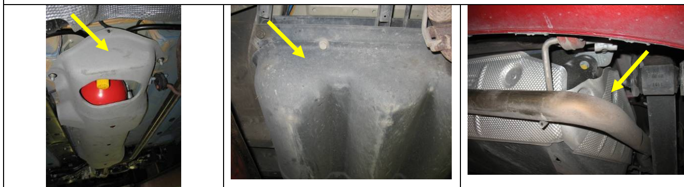
Carter de protection sous véhicule (métallique ou en matériau composite)
