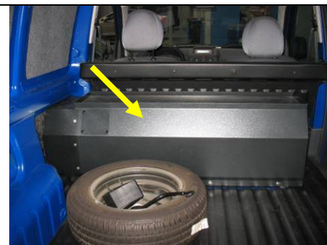
Carter de protection réservoir dans compartiment AR (CTTE)
