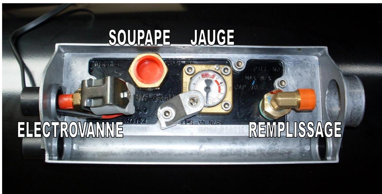
Soupapes de sécurité : 80 Nm et orientation en serrant (plat du haut parallèle à la boîte) à 100 maxi.
