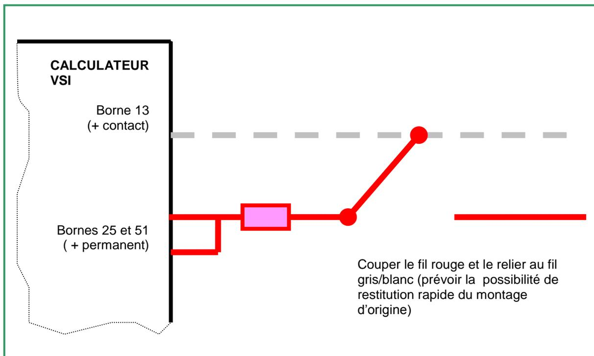
Dans certains cas nous pouvons avoir besoin d'isoler l'alimentation permanente et l'alimenter par le plus contact (consommation de courant lors d'une longue immobilisation de véhicule).
