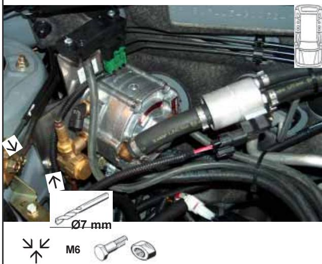
6. Mounting inletmanifold / Montage inlaatspruitstuk /
