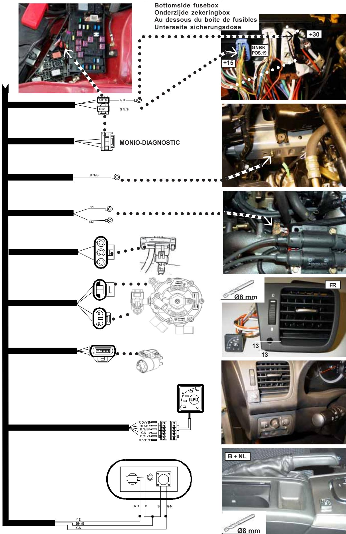
12. Electrical diagram / Electrisch schema / Schéma électrique / Elektronisches Schaltschema
