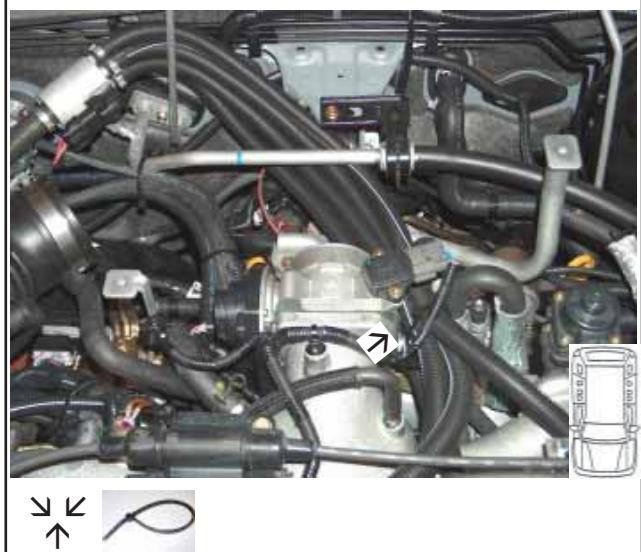
7. Harness leadthrough / Kabeldoorvoer /
