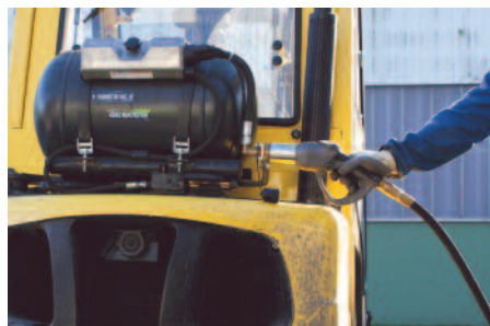
Pistolet de chargement limitant les risques de contact avec le produit.
